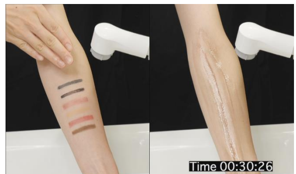
図3 モデル洗浄剤の各種汚れに対する洗浄効果 左画像の上から、アイライナー、フィルムマスカラ、口紅、クリームファンデーション、赤色に着色した皮脂、泥汚れを示し、右画像は洗浄後の状態
